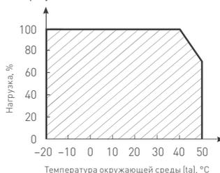
Рис. 3. Максимальная допустимая нагрузка, % от мощности источника
