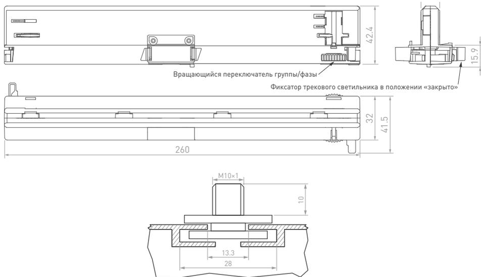
Рисунок 1. Установочная втулка в корпусе источника питания
